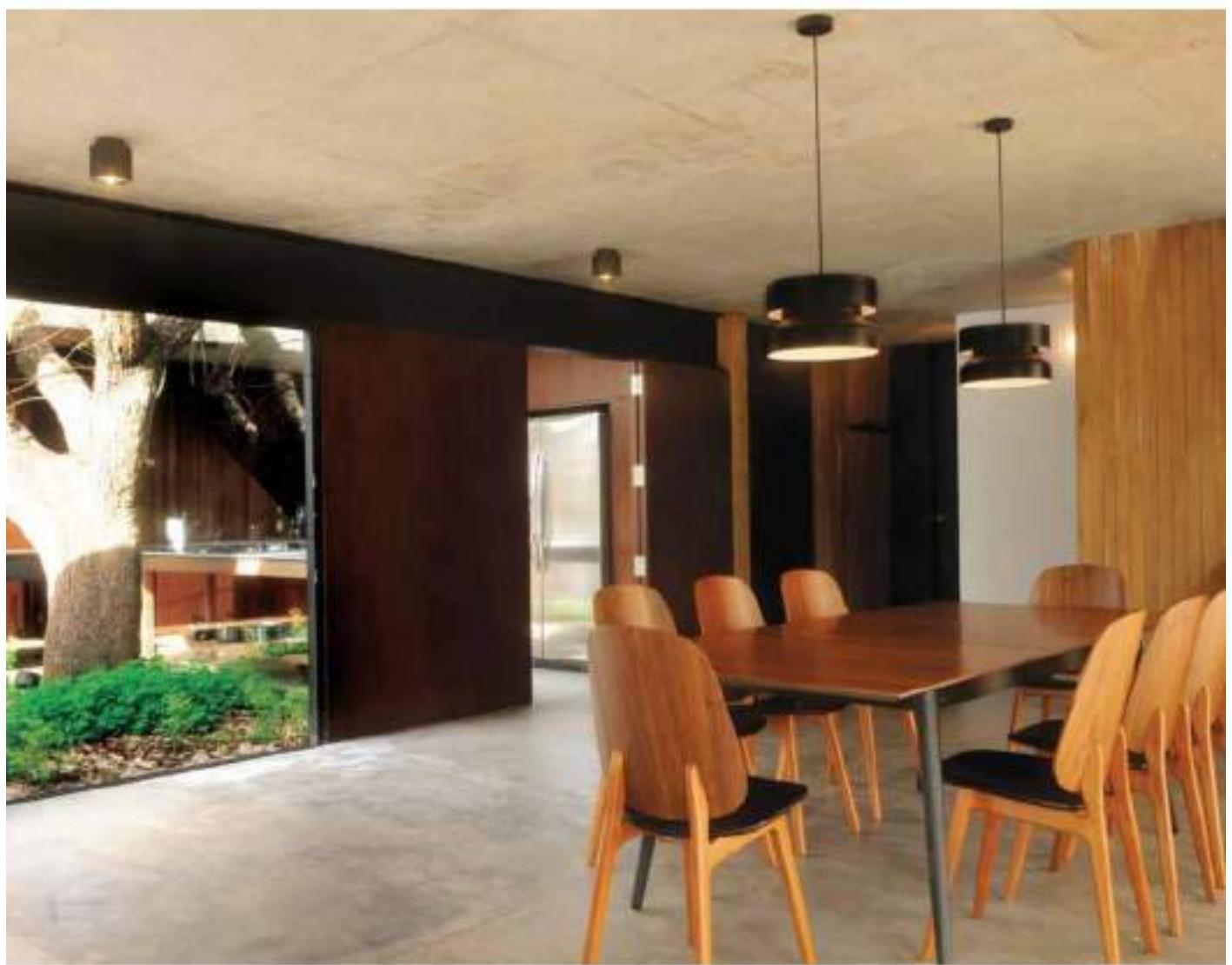
Constructivamente el espacio se da entre una placa de hormigón –con terminación de cemento alisado en el interior y piedra laja San Juan en el exterior– y una losa de hormigón visto sin vigas, sostenida por columnas metálicas que quedan contenidas en el espesor de los muros de cerramiento hechas con sistema Steel Frame, revestidas en yeso en el interior y de tablas de lanacho en el exterior.
